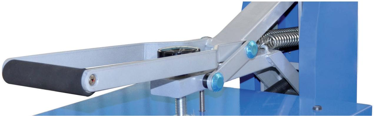
Schließen Sie die Presse bei zu hoch eingestelltem Druck nicht mit Gewalt, da dies zu Beschädigungen an Ihrer Presse führen kann. **Eine solche Beschädigung ist nicht durch die Garantie abgedeckt.**
